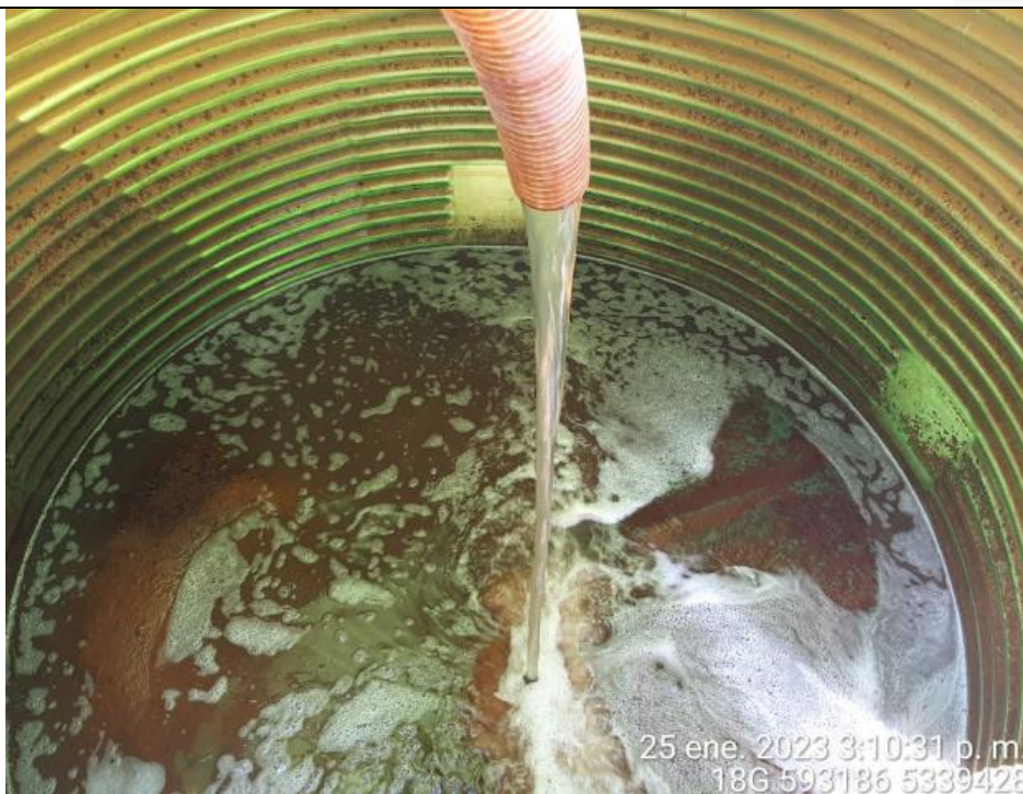
Fotografía N°18: Extracción de Lixiviados a estanque. Tomada: Miércoles 25 de enero del 2023
