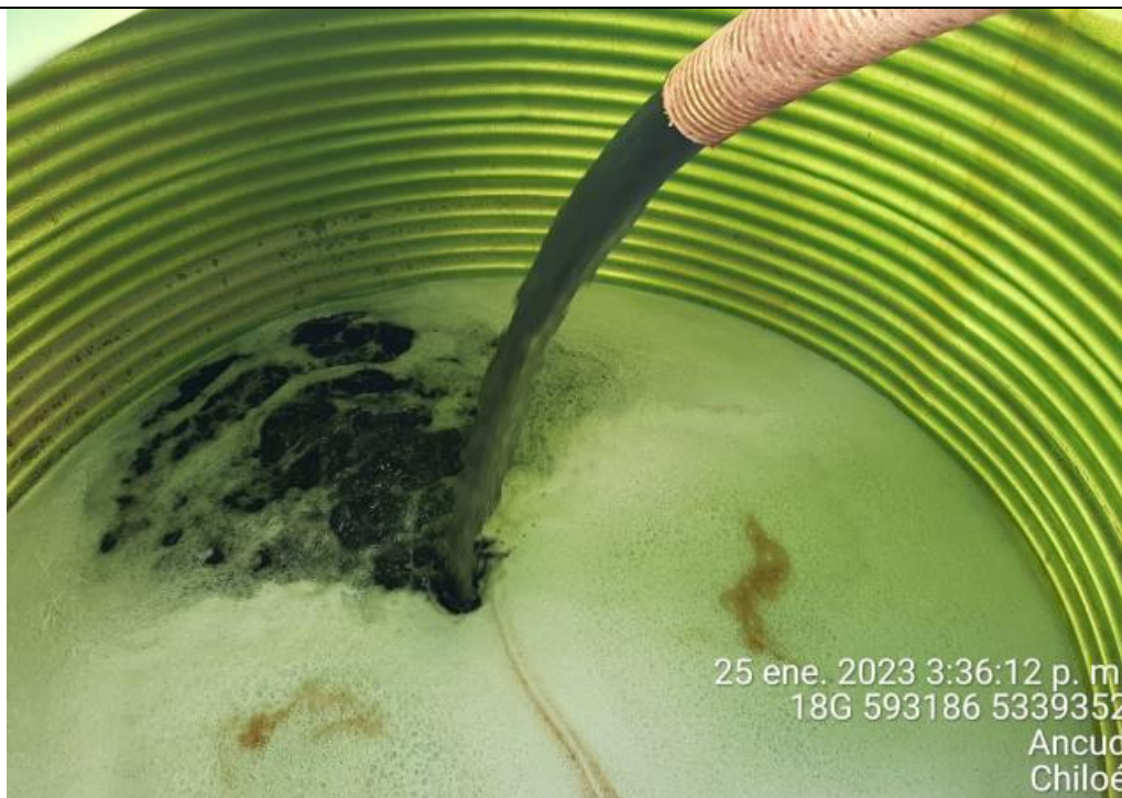
Fotografía N°20: Extracción de Lixiviados a estanque. Tomada: Miércoles 25 de enero del 2023
