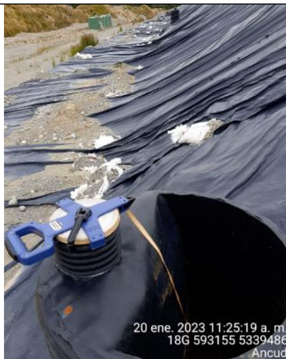
Fotografía N°31: Medición de Niveles de cámaras por Personal Municipal. Tomada: 20 de Enero del 2023.
