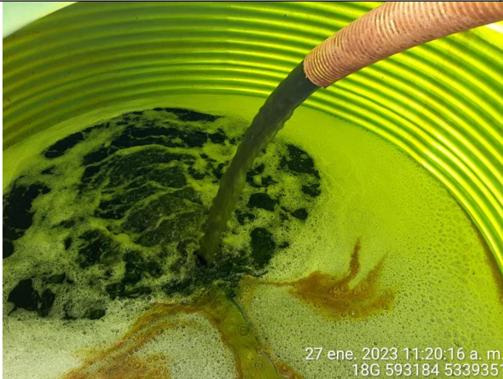
Fotografía N°22: Extracción de Lixiviados a estanque. Tomada: Viernes 27 de Enero del 2023.
