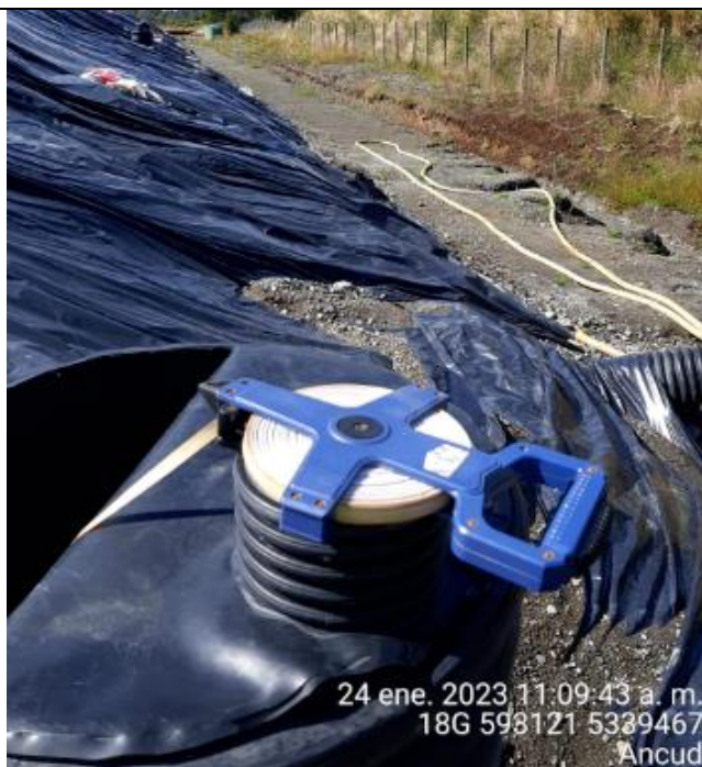
Fotografía N°33: Medición de Niveles de cámaras por Personal Municipal. Tomada: 24 de Enero del 2023.
